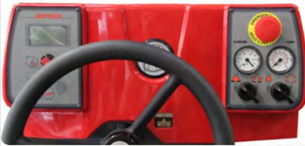
Les boutons de contrôle de la broche sont situés juste derrière le volant afin de modifier ou inverser facilement la vitesse de rotation, ou réinitialiser la mesure de profondeur.
